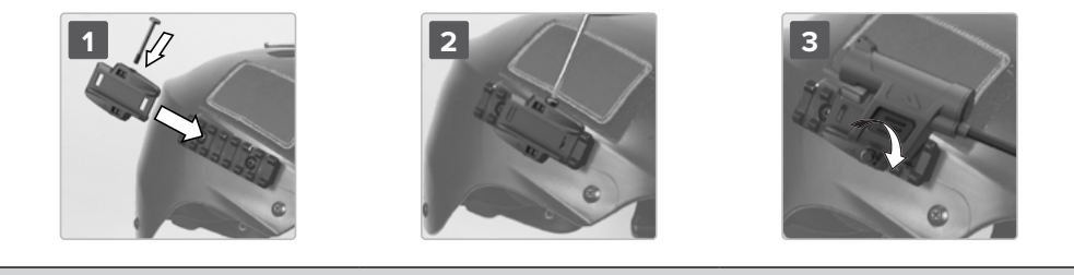
Figura 9 – Montaje sobre riel (ABR)
