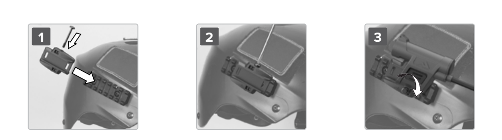
Abbildung 9 – (ABR) Above Rail-Befestigung
